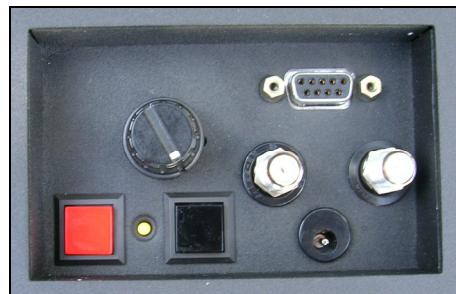
På højre side af instrumentet findes 2 trykknapper for: ON/OFF og navigering / valg. Betjeningen foregår primært med en drejeknap/cursorstyring via LCD-skærmen. Der er tilslutning for extern netdel, samt RS 232-børsning for softwareopdatering og en resetknap. Instrumentet kan måle 2 satellitsignaler samtidig, via 2 F-connectorer. Der er dog kun 22 kHz-styring og DiSEqC-kommandoer fra indgang A.
