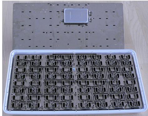
Panelantennen ser ud til at indeholde 64 vertikale og 64 horizontale hornantennen, som adskilt er forbundet til hinanden via et "waveguide" kanalsystem. De to polariteter "feedes" separat til den integrerede twin LNB på bagsiden.
